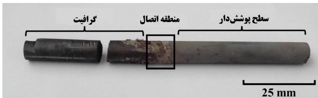
شکل ۶: نمونه شکسته شده پس از آزمایش کشش برای ارزیابی استحکام چسبندگی.
