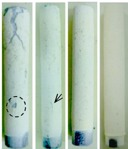
شکل ۳. تصویر دیجیتالی ظاهر پوشش NiAl-8YSZ پس از سیکل‌های مختلف آزمون شوک حرارتی.
