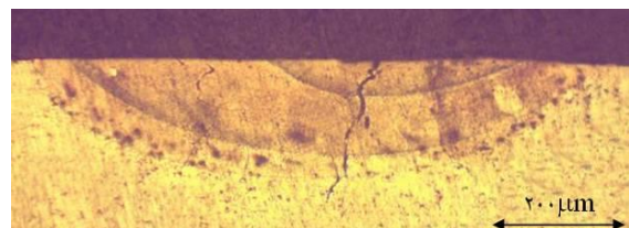
شکل ۲. تصویر میکروسکوپی نوری از سطح مقطع عرضی لایه ذوب سطحی شده توسط لیزر با انرژی ۵ ژول و سرعت روبش ۳/۵ میلیمتر بر ثانیه.
