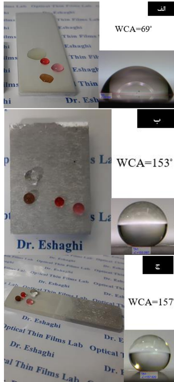
شکل ۲. تصاویر از سطح زیرلایه: الف) آلومینیم اولیه، ب) آلومینیم اچ شده + PFTS و ج) آلومینوم آندایز شده + PFTS، به همراه زاویه تماس آنها.
