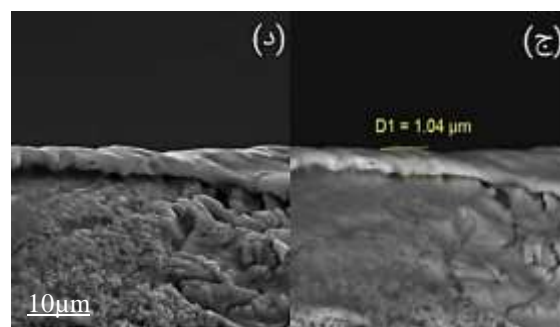
شکل ۵. تصاویر SEM برای نمونه آبکاری شده در زمان ۵۰ min از: (الف) سطح در حالت الکترون برگشتی، (ب) سطح در حالت الکترون ثانویه، (ج) مقطع در حالت الکترون برگشتی، (د) مقطع در حالت الکترون ثانویه.
