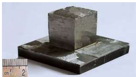
شکل ۲. تصویر ماکروسکپی از نمونه ساخت افزایشی به صورت دیواری و مکعبی به ابعاد ۲×۲ cm.
