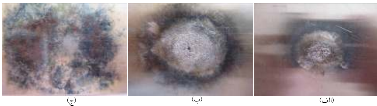
شکل ۵. نمونه‌های آلومینیوم پرتودهی شده توسط یون‌های Ar در فواصل، الف) ۱ cm ب) ۴ cm ج) ۱۰ cm از نوک آند
