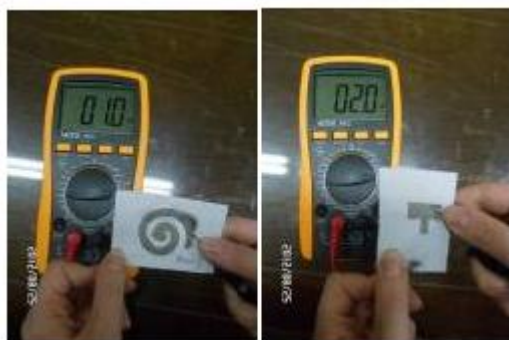
شکل ۱۶. ظرفیت خازنی اندازه گیری شده در طرحهای آنتنی مختلف.
