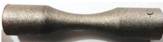
شکل ۲. سطوح نمونه (الف) سطح نمونه پولیش شده، (ب) سطح نمونه بعد از عملیات شات پینینگ.
