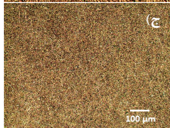
شکل ۲. الف) تصویر میکروسکوپی نوری ریز ساختار فلز پایه، تصویر میکروسکوپی نوری ریز ساختار ناحیه اغتشاشی: (ب) نمونه تحت فرآیند بدون ذرات تقویت کننده (ج) نمونه کامپوزیتی.
