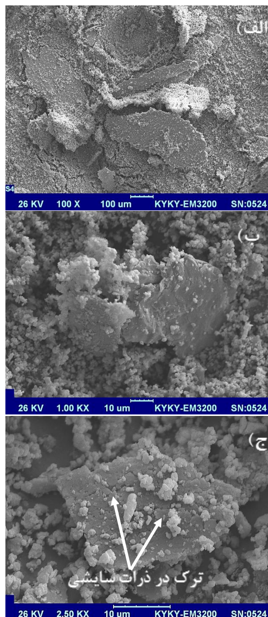
شکل ۸. تصویر SEM از ذرات سایشی: (الف) فلز پایه، (ب) نمونه تحت فرآیند بدون ذرات تقویت‌کننده و (ج) نمونه کامپوزیتی.
