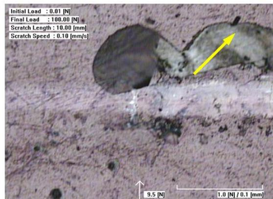
شکل ۹. نحوه شکست و جدایش پوشش‌های TiAlN در آزمون خراش در دو حالت مختلف: الف) عاری از لایه سفید و ب) حاوی لایه سفید.
