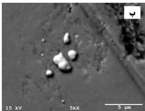
شکل ۱۰. تصاویر میکروسکوپی لایه‌های تریبوفیلیم در سطح سایش پوشش Ni-P-Ag-Al 2 O 3 در حالت سایش (الف) دمای محیط و (ب) دمای بالا.
