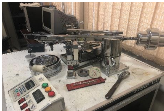
شکل ۱. تصویر دستگاه تست سایش پین روی دیسک.
