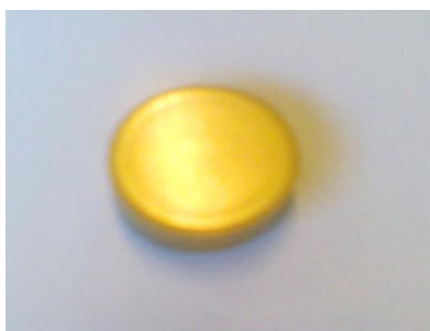
شکل ۲. نمونه پوشش دهی شده با TiN در دمای 470^{\circ}\text{C} .
