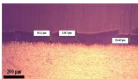
شکل ۲. تصویر میکروسکوپی نوری از سطح مقطع نمونه پیش نشست شده با گرافیت به ضخامت حدود ۱۳۰-۱۱۰ μm.
