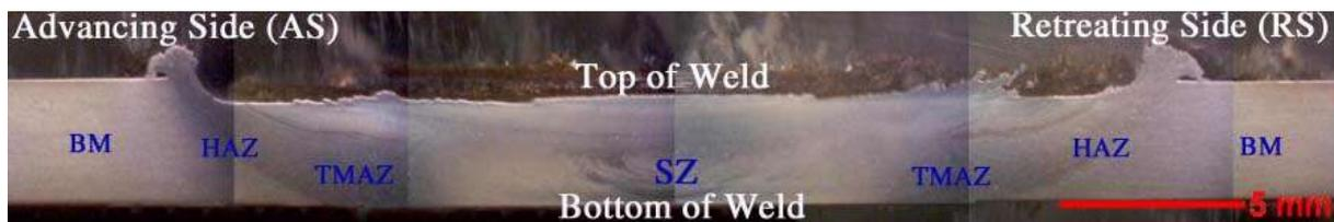
شکل ۲. تصویر میکروساختار از مقطع جوش.
