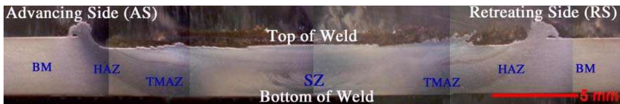
شکل ۲. تصویر میکروساختار از مقطع جوش.
