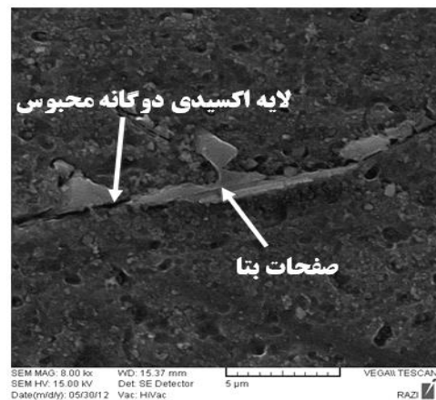
شکل ۷. چگونگی جوانه زنی و اشاعه ترک از فصل مشترک فاز بتا با زمینه در آلیاژ \text{Al-5Si-1.2Fe} .
