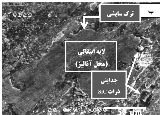
شکل ۹. سطح سایش در دمای ۲۰۰ درجه سانتیگراد، الف) بزرگنمایی کم و ب) بزرگنمایی بالا.
