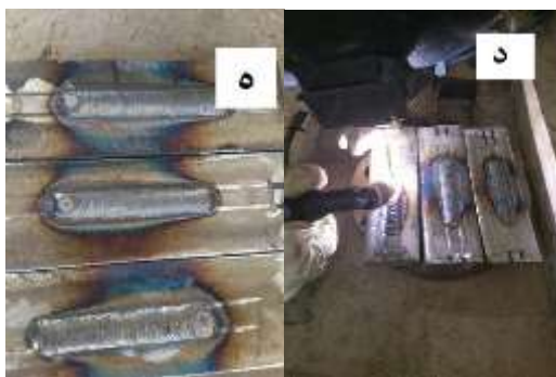
شکل ۱. نمایشی از روند تهیه نمونه‌ها در حین الف) آماده سازی سطحی، ب) تراز کردن دو قطعه ج) جوشکاری د) و ه) تصاویر سه نمونه جوشکاری سطحی شده
