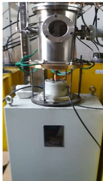
شکل ۲. نمایی از الف) دستگاه پلاسمای کانونی MTPF-2 و ب) طرحواره داخلی این دستگاه.
