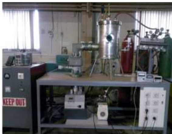
شکل ۱. نمایی از الف) دستگاه PECVD و ب) طرحواره داخلی این دستگاه.
