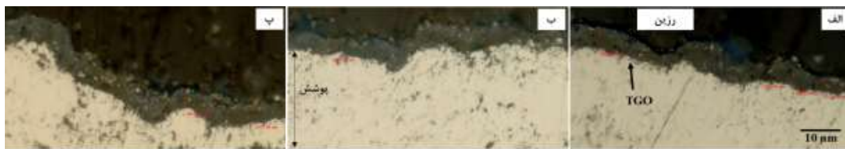
شکل ۱۳: تصاویر میکروسکوپی نوری از سطح مقطع پوشش‌ها پس از آزمایش اکسیداسیون به مدت ۲۰۰ ساعت: الف) M، ب) M2A، پ) M4A.
