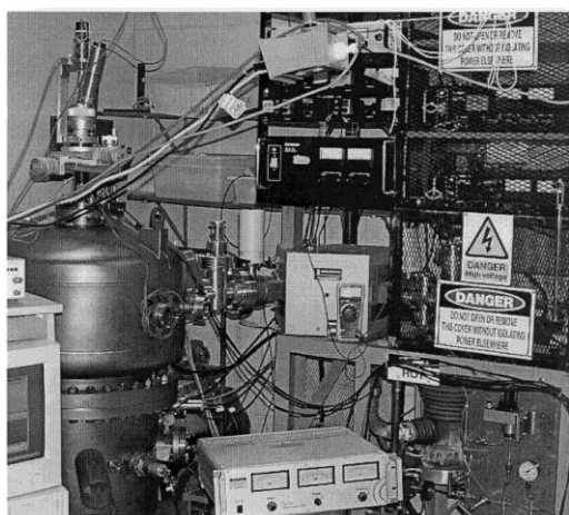
شکل ۱. اتاقک هدف Leybold – Heraeus بکاررفته برای آزمایشات.
