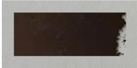
شکل ۵. تصویر ماکروسکوپی از نمونه رسوب داده شده با نرخ شارش \text{GeH}_4:\text{CH}_4 = 1:130 (S4) پس از ۹۶ ساعت قرارگیری در معرض مه نمکی.
