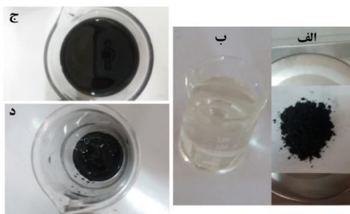
شکل ۲. الف: پودر گرافیت. ب: محلول شفاف متیل پیرولیدن. ج: گرافن‌های تشکیل شده بر روی محلول. د: گرافن‌های تشکیل شده در ته بشر با ضخامت بیشتر.
