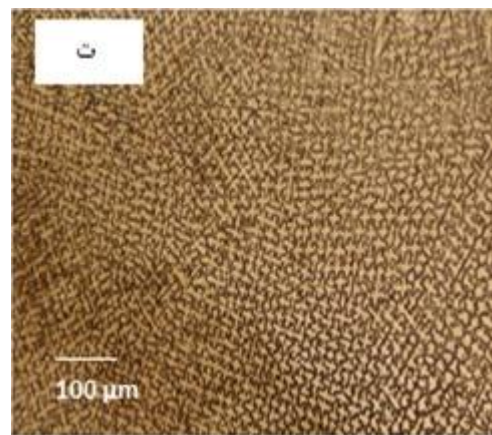
شکل ۲. (الف) انجماد صفحه‌ای، (ب) ریزساختار سلولی حاصل از انجماد، (پ) دندریته‌های ستونی، (ت) رشد دندریته‌ها به صورت هم محور.
