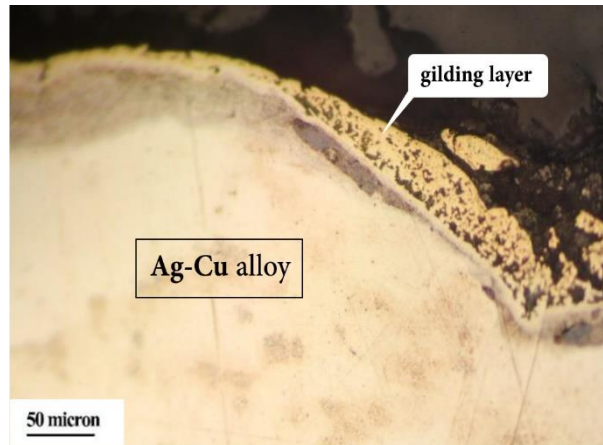
شکل ۷. لایه طلا در نمونه GS06-16 به صورت متخلخل و پرداخت نشده در قسمت فرورفته سطح در سمت راست شکل مشاهده می‌شود. لایه طلا در سمت چپ شکل (قسمت برجسته سطح) پرداخت و صیقل کاری شده و در نتیجه متراکم شده است.
