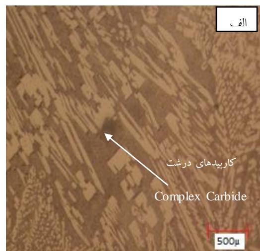
شکل ۱. (الف): تصویر میکروسکوپی نوری برای نمونه شماره ۱، (ب): تصویر میکروسکوپی نوری برای نمونه ۲.
