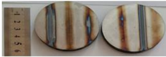
شکل ۳. تصویر نمونه‌های سختکاری سطحی شده لیزری با لیزر دیودی (قطر نمونه 65 میلی‌متر).
