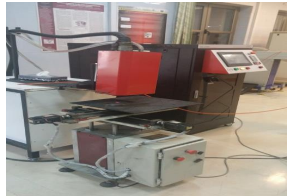
شکل ۱. تصویر دستگاه لیزر دیودی در حین فرآیند سختکاری.
