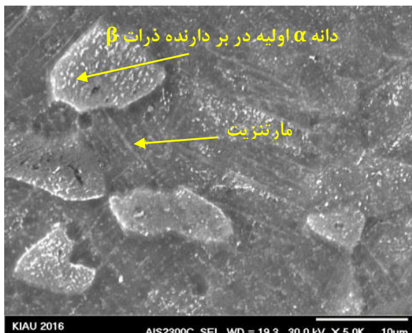
شکل ۵. تصویر SEM ریز ساختار نمونه ۳ شامل ذرات \beta دانه های \alpha اولیه و تیغه های مارتنزیت.
