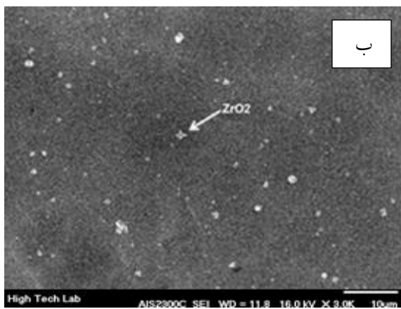
شکل ۱۴. الف، ریز ساختار نمونه بدون نانو ذرات. ب: ریز ساختار نمونه با حضور نانو ذرات.
