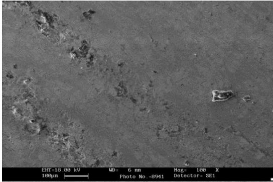
شکل ۱۱. سطوح ساییده شده نمونه ۷ پوشش ۸۰٪ Wc+۲۰٪ Ni
