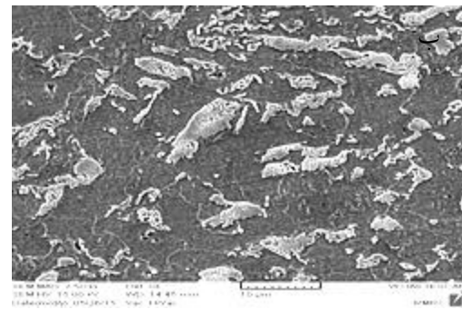
شکل ۶. ساختار فلز پایه. الف) با استفاده از میکروسکوپ نوری، ب) با استفاده از SEM در مدالکترون برگشتی.
