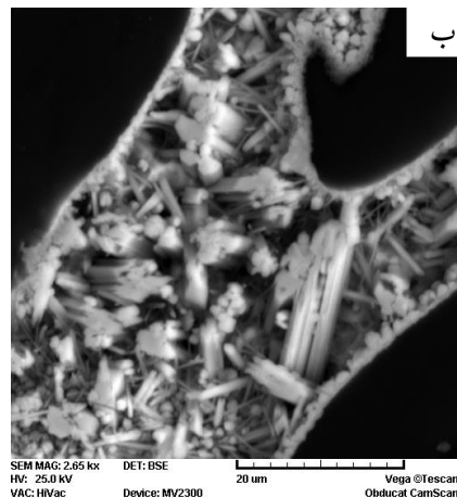
شکل ۷ الف و ب. تصاویر الکترونیکی برگشتی از مقطع لایه کامپوزیتی سطحی ایجاد شده در بزرگ‌نمایی‌های مختلف.
