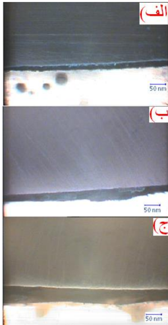
شکل ۱۳. تصاویر میکروسکوپ نوری از پوشش‌های سنتز شده با اعمال ولتاژ ۵۰ ولت و در محیط‌های (الف) اتانولی، (ب) بوتانولی و (ج) ایزوپروپانولی.
