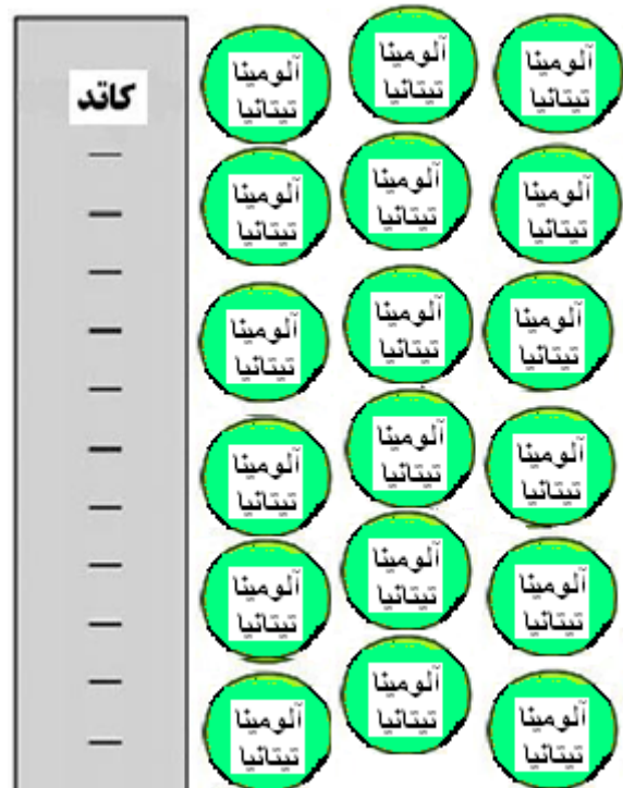
شکل ۶. شماتیکی از ذرات آلومینا - تیتانیا پوشش داده شده بر روی زیرلایه‌های فولادی با بار مخالف.
