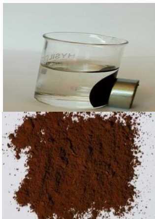
شکل ۱. فرآیند ته‌نشینی نانوذرات مگه‌مایت به کمک یک آهنربا (سمت راست) پودر نانوذرات مگه‌مایت (سمت چپ)
