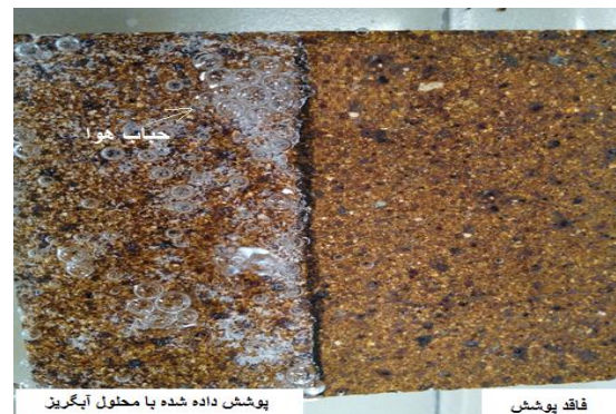
شکل ۹. تنفس پذیری آجر پوشش داده شده با لایه نفوذی ابر آبگریز.
