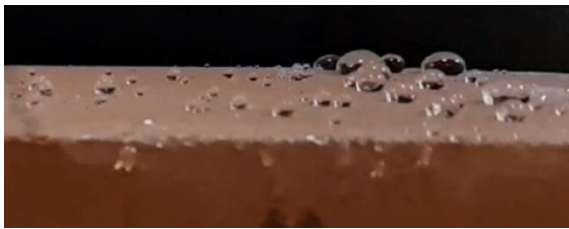
شکل ۷. قطرات آب بر سطح آجر با لایه نفوذی ابر آبگریز.
