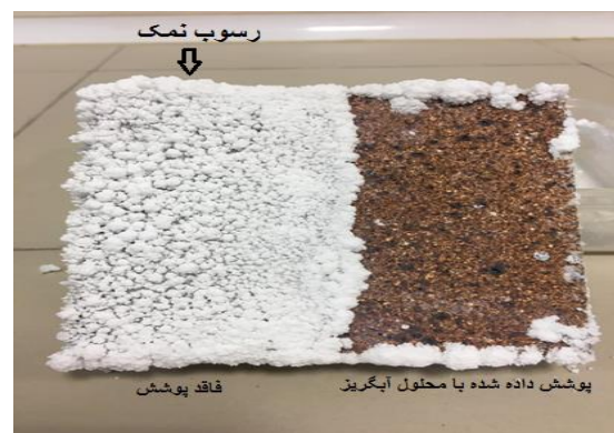
شکل ۱۰. آزمون شوره روی آجر با لایه نفوذی ابر آبگریز و بدون آن.
