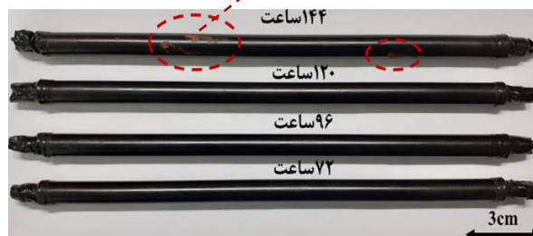
شکل ۷. نمونه های فولادی QPQ شده بعد از زمان های مختلف آزمون خوردگی پاشش نمک.
