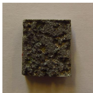
شکل ۶. تصویر دیجیتالی از سطح خورده شده آلیاژ پایه.
