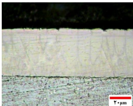
شکل ۲. سطح مقطع پوشش نیکل-بور الکترولس به ضخامت حدود ۴۰ µm (نمونه ۶).
