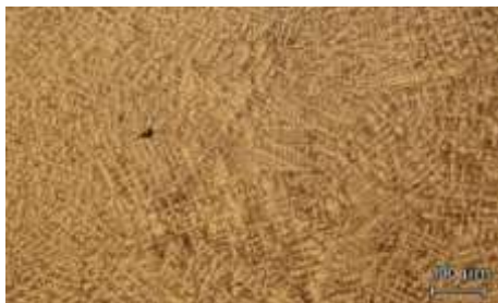
شکل ۲. ریزساختار روکش ایجاد شده.
