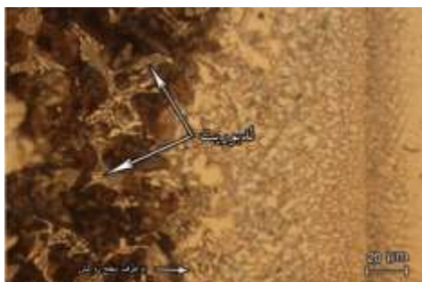
شکل ۶. تشکیل ساختار لدبوریت در منطقه ذوب جزئی شده.
