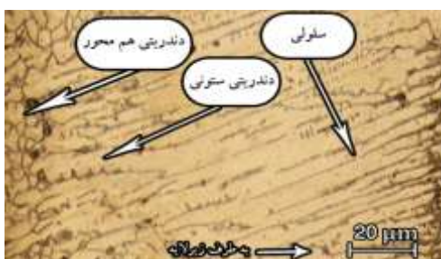
شکل ۵. تغییر ریزساختار جوش از فصل مشترک به طرف سطح روکش.
