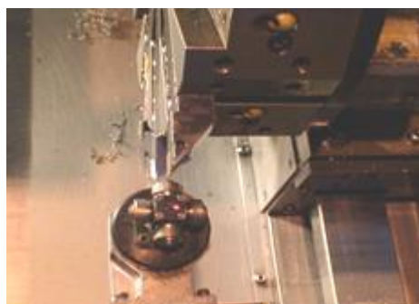
شکل ۲. استفاده از لبه یاب لیزری جهت مماس کردن ابزار.
