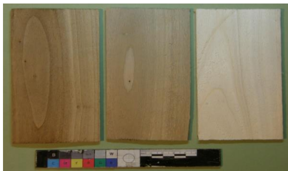
شکل ۱. نمونه های چوب مورد مطالعه: شاهد (راست)، ۳۰۰ ساعت هوازده (وسط) و ۸۰۰ ساعت هوازده (چپ).
