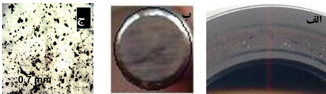
شکل ۱۲- الف) ۷× رد سایش نمونه TiC-NiAl (ب) ۷× سطح سایش پین (ج) ۱۴× ذرات حاصل از سایش.
