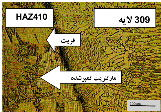
شکل ۶. تصویر میکروسکوپ نوری زیر لایه ۴۱۰ و پوشش ۳۰۹
